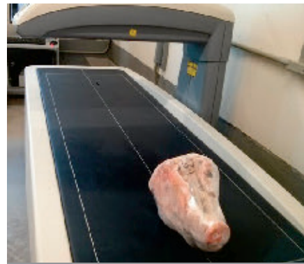
Numérisation d'une tête de porc permettant d'évaluer la minéralisation d'un élevage ou d'une stratégie d'alimentation
